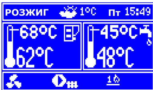
Рис. 4 Сигнализация режима РОЗЖИГ и номера попытки.
