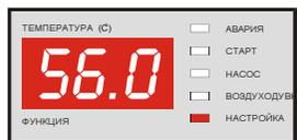
Для увеличения установленной температуры следует нажать (или придержать) кнопку **СТАРТ**
